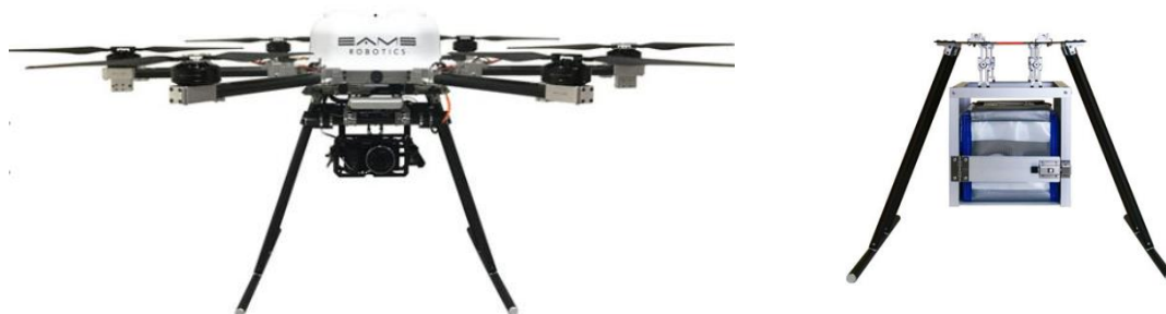
＜当日利用予定のドローン機体（左）と輸送BOX（右）＞ ドローン機体名：UAV-E6106FLMP（イームズロボティクス社）
