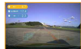
ドライブレコーダーとAI技術を活用し、滑走路点検を省力化
